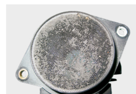
Verstopfter Luftmassensensor (LMS)
