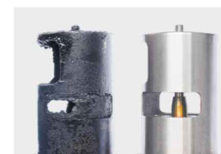
Verklebtes AGR-Ventil (Diesel) und im Neuzustand
